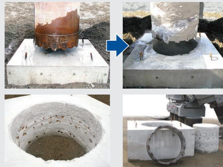
リングビットの規格を変えることにより、多様な地盤への適用が可能です。
