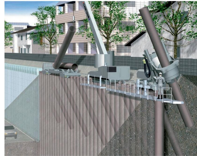
ジャイロパイラーは、傾斜機構付きで反力杭をつかんだ姿勢で控杭や前面支持杭などの斜杭を回転圧入できます。この構造により、大きな水平荷重が作用する壁高の高い構造物の構築が可能です。
