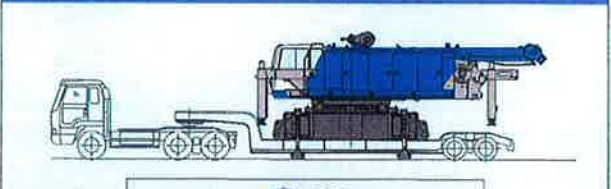
5 アッパーとロアフレーム連結後、ロアジャッキを張り、アッパージャッキを縮める
