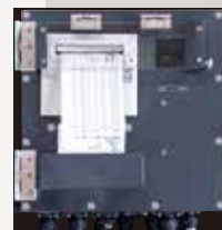
コントロールボックス部 データ記録
